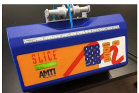
4. ADJUST TOP ROLLER GUIDE WITH MAETRAIL INSERTED. MATERIAL MUST BE CENTERED.
